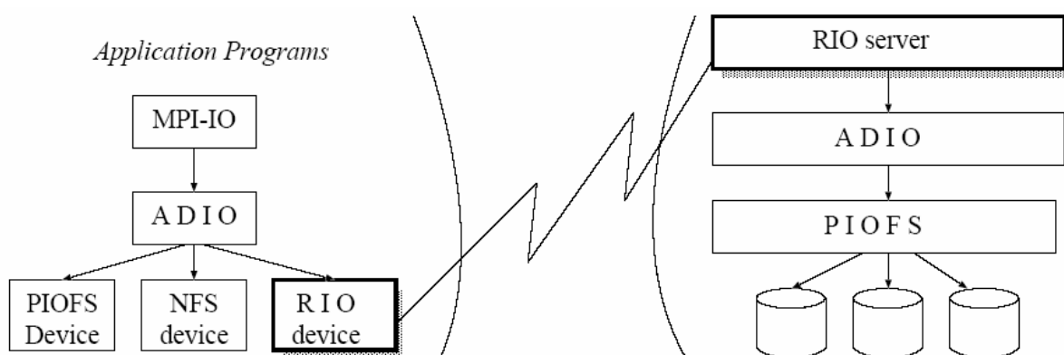
Abbildung 1: Architektur von RIO (links:Client - rechts:Server) [aus: Foster et al. 1997]
